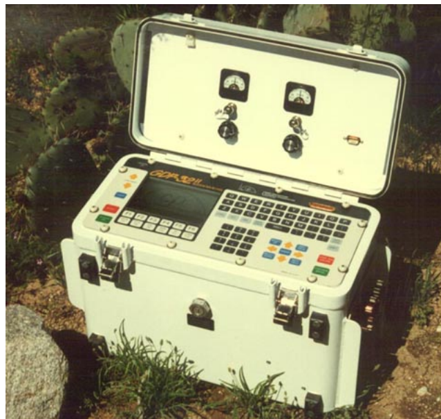
Figura 15. Receptor de Zonge (GPD32)
